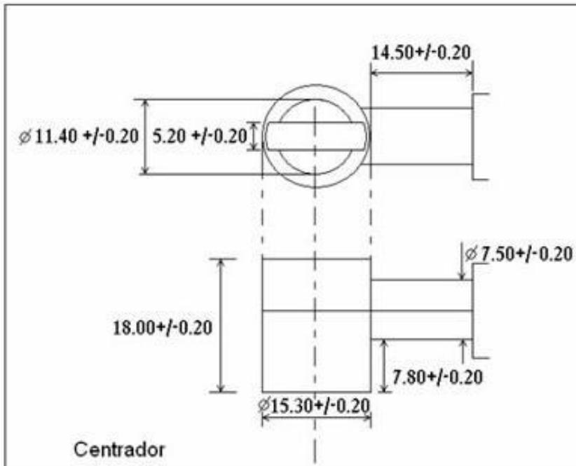
Diámetro máximo de los orificios de los centradores será de 4 mm.
