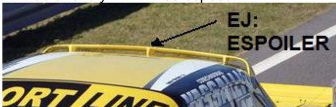
**93.3** Se autoriza en los Ford Falcón la prolongación de la parte superior del baúl, para alcanzar la máxima medida de la posición del spoiler, esta prolongación deberá ser de un solo segmento, y ser horizontal al automóvil con una tolerancia  $\pm 2^\circ$  y deberá comenzar a 400mm como mínimo del inicio de la tapa de baúl en punto medio, de ser necesario está permitido reforzar esta prolongación, el o los refuerzos deberá ser puntuales y estar ubicado en la parte trasera inferior.
